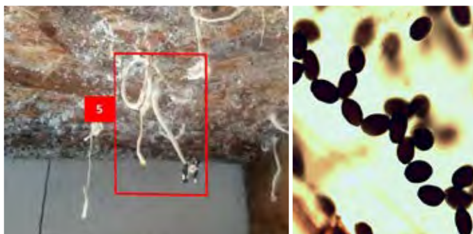
Obr. 4 Odobratá vzorka huby pre zisťovanie druhu a výtrusy plodnice zisteného hnojníka, rozmer výtrusov 9,99-13,1 × 6,1-8,1 μm [1].
