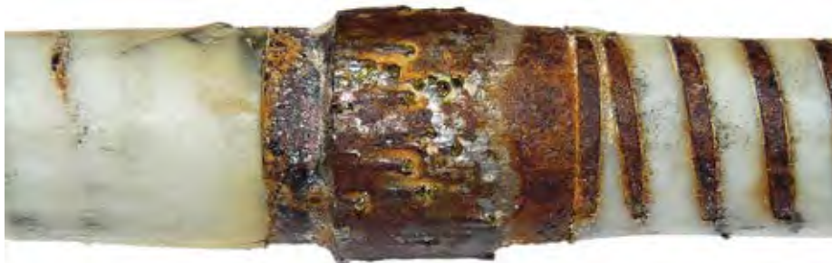
Obr. 3 Priemyselné diamanty na krúžku rezného lana, Španielsko
