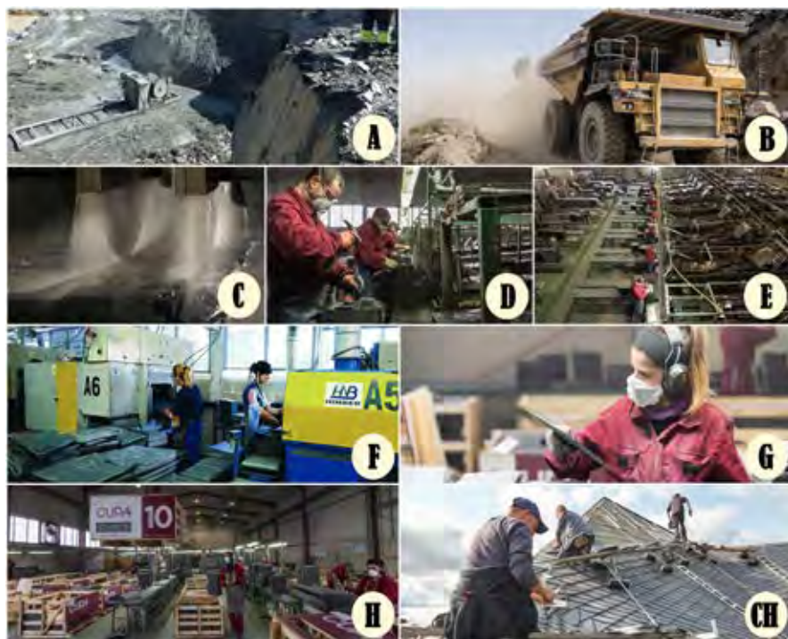
Obr. 1. Proces výroby pokrývačskej bridlice
